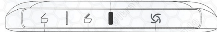
Окно наблюдения за источником окружающего света Сенсорная клавиша управления крышкой Сенсорная клавиша управления сиденьем Сенсорная клавиша смыва
