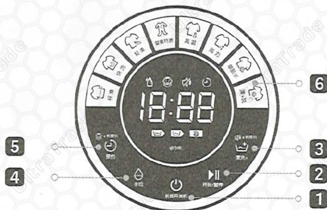
**1** Кнопка "Включение / Выключение" Пользователь может включать и выключать стиральную машину долгим нажатием кнопки.
