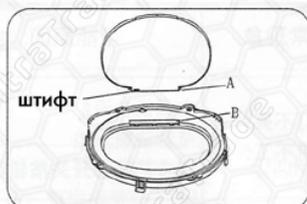
1. Достаньте Защитную крышку из пакета с принадлежностями. Сопоставьте ось крышки - А с отверстием - В.
